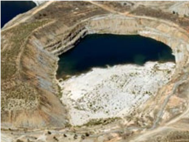
在采空露天矿坑中联合处置的废石和浓缩尾矿
