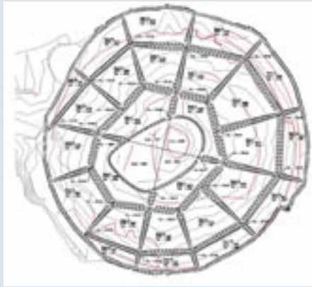
平面图，其中显示表层小池收集降雨，尽量减少坡面侵蚀
