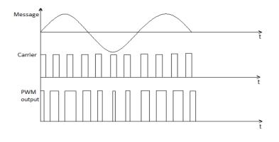
Figure 6 : PWM Waveform Generation
