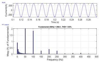
Fig. 14. (d) THD<sub>i</sub> of distribution N/W with zigzag T/F
