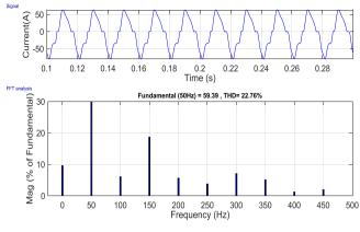
Fig. 13. (d) Current THD of distribution N/W
