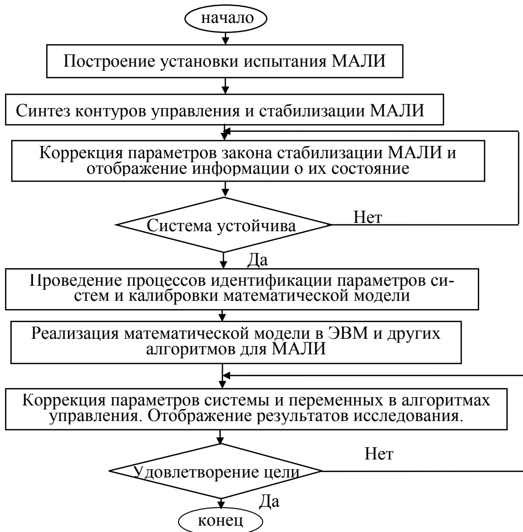
Рис. 5. Схема построения комплексного эксперимента МАЛИ с математическим моделированием
