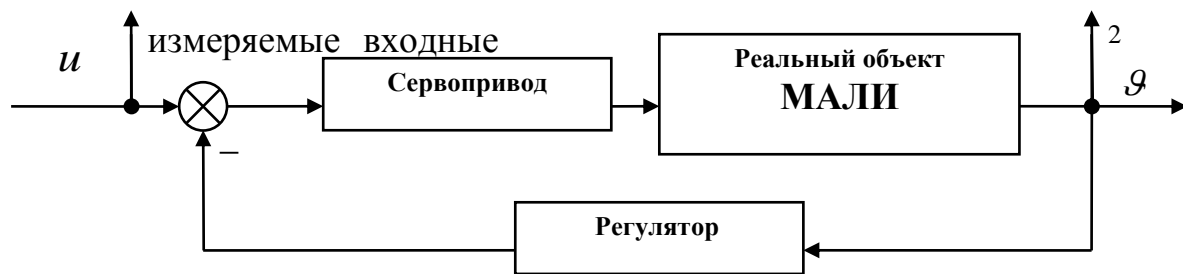
Рис. 6. Структурная схема идентификации параметров продольного канала управления МАЛИ: 1- 2- измеряемые выходные сигналы
