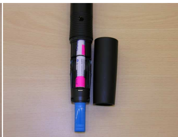
Fot. 9 Mikrofon bezprzewodowy "do ręki" z otwartą komorą na baterie
