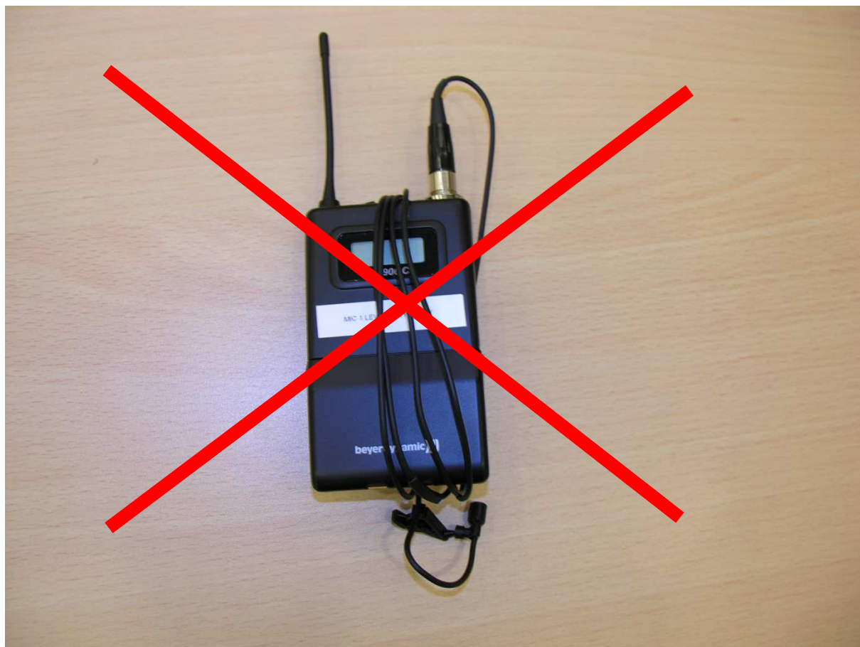
Fot. 27 Niewłaściwy sposób postępowania z mikrofonem
