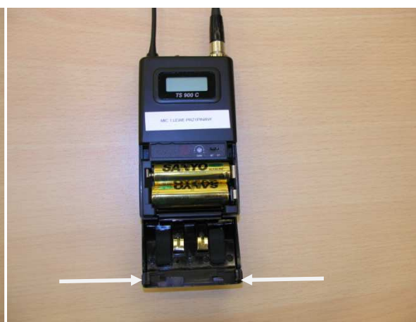
Fot. 11 Mikrofon bezprzewodowy "przypinany" z otwartą komorą na baterie
