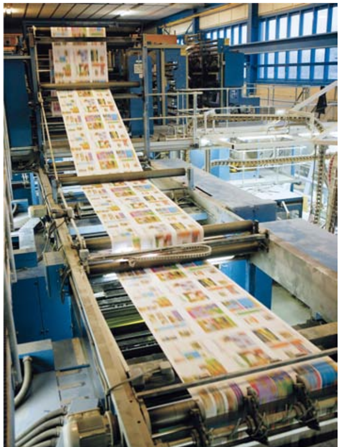
Produktionsraum einer Druckerei mit Rollenoffsetmaschine
