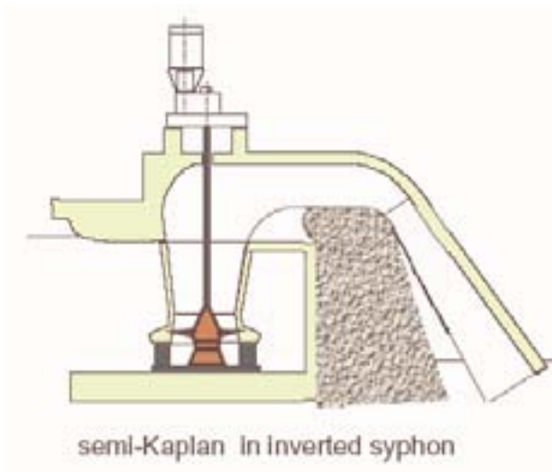
Abbildung 6.16: Querschnitt einer Kaplanmaschine mit umgekehrtem Heber
