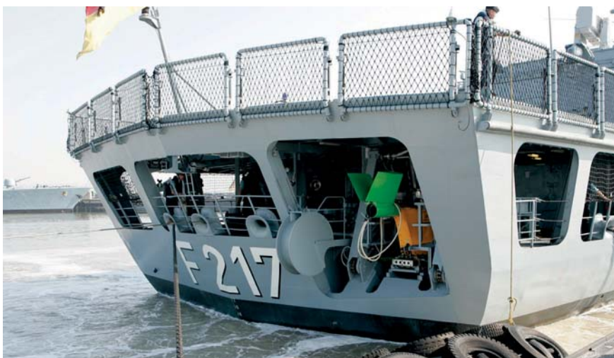
Versuchseinbau eines Low Frequency Towed Active Sonar (LFTAS) im Heckbereich der Fregatte BAYERN
