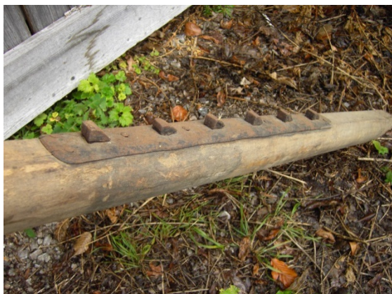
Das Hebscheidt als „hebender“= haltender Teil des Wagenhebers
