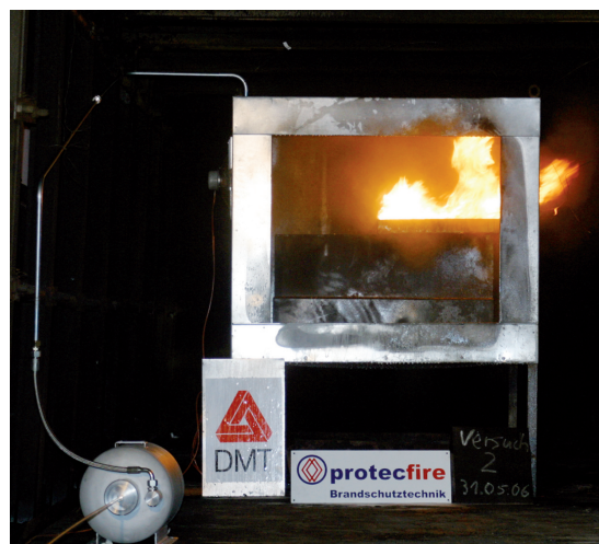
Bild 9. Brand in der Motorraumattrappe.
