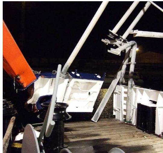
Schaden an der Verschanzung
