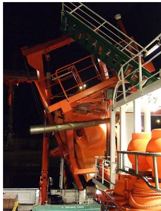
Boot und Ablaufbahn unbrauchbar
