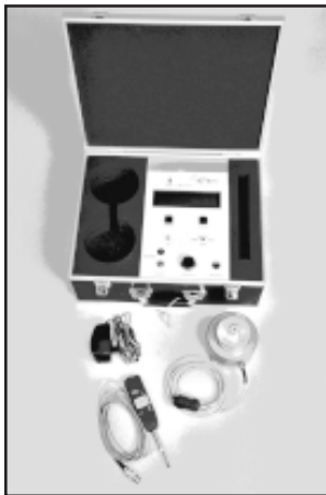
autom. Prüf- und Auswerteeinheit mit Speicher und Druckerschnittstelle
