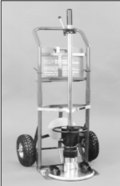
Fallgewichtsgerät mit Transportwagen und Magnetplatte
