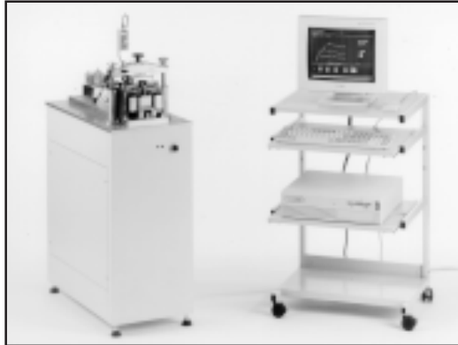
Rahmenschergerät SM-E mit Mehrstellen-Steuergerät
