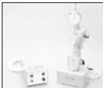
Konuspenetrometer mit elektrischer Fallstab- führung
