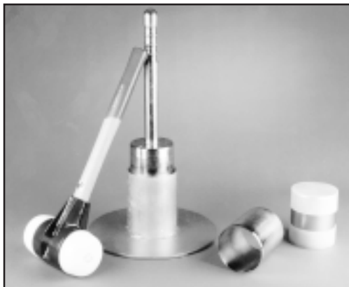
Ausstechzylinder mit Schlaghaube, Bodenplatte und Hammer
