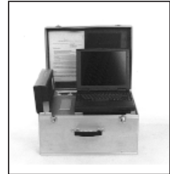
autom. Prüf- und Auswerteeinheit über Notebook
