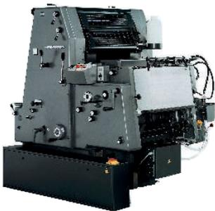
Die GTO ermöglichte echten Qualitätsdruck im Kleinformat. Sie brachte es auf eine Geschwindigkeit von 8.000 Druckbogen pro Stunde
