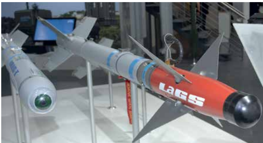
Lasergelenkte Sidewinder LaGS (Laser Guided Sidewinder) als leichte Luft/Boden-Lenkwanne von Diehl
