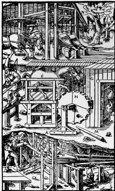
Stroje na čerpání důlních plynů ze štol, 1556, reproza: Georgius Agricola, Dvanáct knih o hornictví a hutnictví, NTM 1976.
