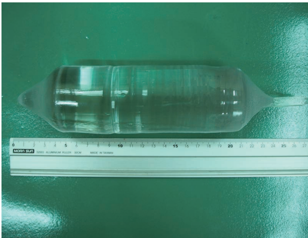
光學元件的製作必須使用大量的晶體材料，柴式提拉法 (Czochralski pulling method) 是一種從溶液中提拉晶體的方法，可快速生長大尺寸的高品質晶體。圖中顯示的是運用這個方法所生長的鋁鎵氮單晶。
