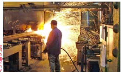
Unter enormem Druck werden Weichenteile verschweißt.
