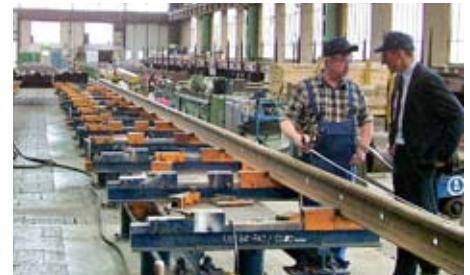
Für die Vormontage werden die Weichen aufgebockt.
