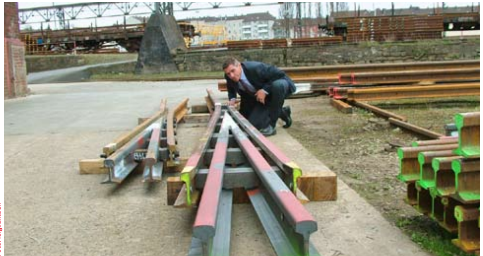
Prüfender Blick: Hubertus Willeke, Leiter des Weichenwerks Witten, erläutert die Vorteile eines Bainit-Herzstücks
