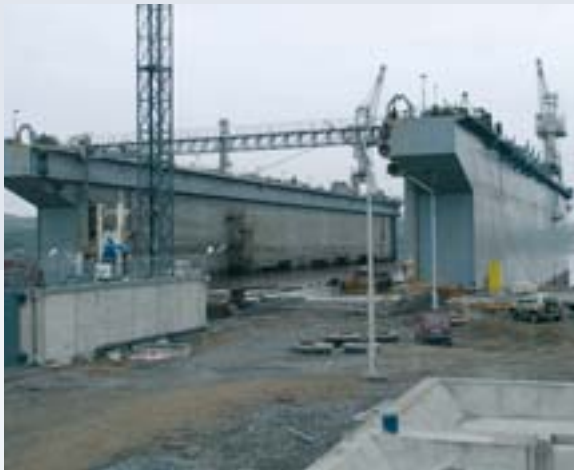
Schwimmdock PD 42: Transportmittel für Reaktor-sektionen von der Schiffsreparaturwerft „Nerpa“ zur Sajda-Bucht
