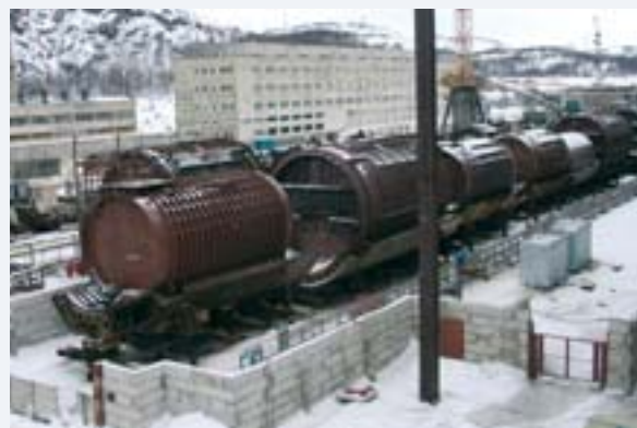
Zerlegeplatz/Pufferlagerplatz zur Lagerung von Reaktor-sektionen
