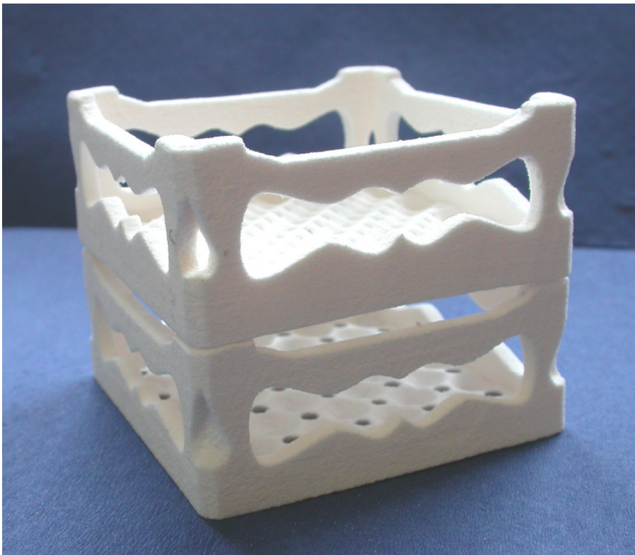
Abb. 3: Sintertrays aus Aluminiumoxid hergestellt mittels 3D-Druck nach dem Brand
