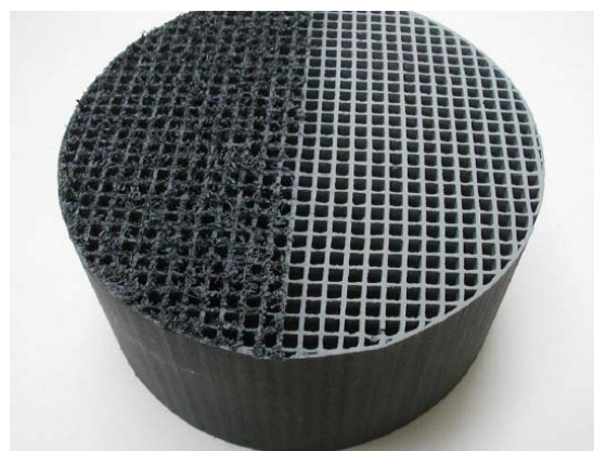
Bild 13 Katalysatoreinsatz mit halbseitigem Flugaschebelag
