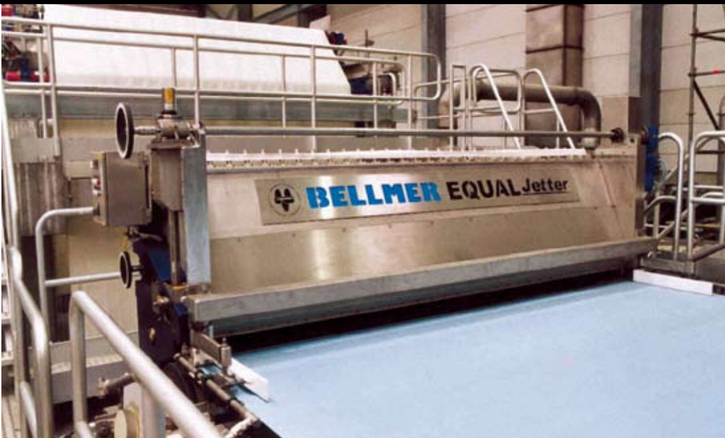
Abb. links: Das einzigartige Verfahren mit bis zu 6 Entwässerungsstufen Abb. rechts: Stoffauflauf zur Papierherstellung in der Praxis
