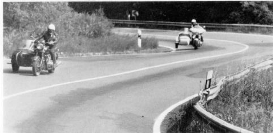
Bild 9: Sie beherrschen das Spiel der Kräfte. Ein „linksdrehendes Moment“ hebt den weißen Seitenwagen hoch.
