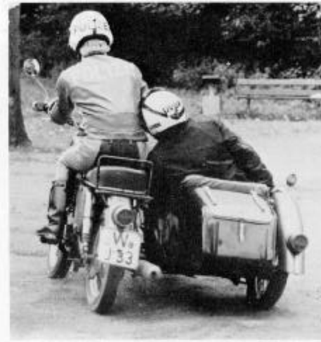
Bild 11: Auch Polizisten lernen Gespannfahren. Nach einer schnellen Linkskurve, die Seitenwagenfederung ist noch eingedrückt, steht der SW-Reifen noch neben der Felge.
