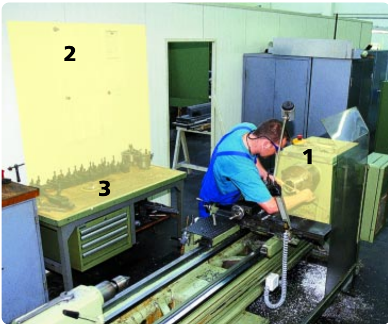
Bild 9: Beispiel für die Bereiche der Sehaufgabe entsprechend den unterschiedlichen Anforderungen am Arbeitsplatz: Drehen und Messen mittelfeiner Teile mit vertikalen und horizontalen Sehaufgaben (1), Lesen von Zeichnungen an vertikalen Flächen (2), Messen am Werkstück und Ablage der Werkzeuge (3)
