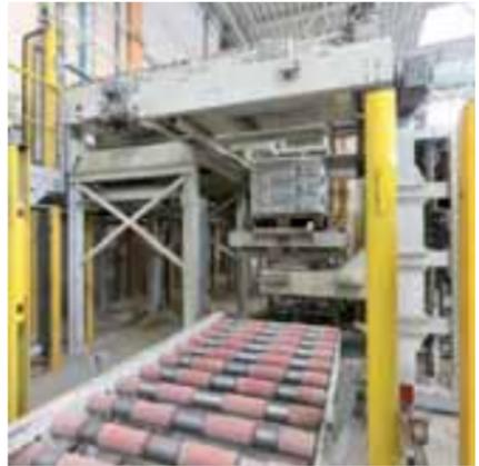
Vollautomatische Palettierung im Trockenmörtelwerk der SCHWENK Putztechnik
