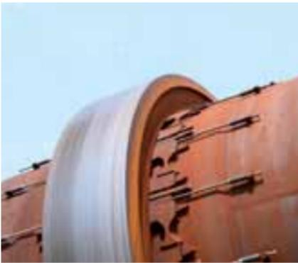
Bild 5: Drehrohrofen mit Laufring
