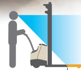
**Die niedrige Bauhöhe der abgeschrägten Gerätefront und der Freisichtmast** der Crown Hochhubwagen-Serie garantieren optimale Sicht auf die Gabelspitzen (in der Regel 50 Prozent der gesamten Gabellänge).
