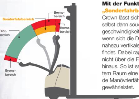
**Mit der Funktion „Sonderfahrbereich“** von Crown lässt sich das Fahrzeug selbst dann souverän in Kriechgeschwindigkeit manövrieren, wenn sich die Deichsel in einer nahezu vertikalen Position befindet. Dabei ragt die Deichsel nicht über die Fahrzeugkontur hinaus. So ist selbst auf engstem Raum eine hervorragende Manövrierfähigkeit gewährleistet.
