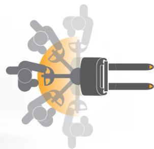
**Die mittig angebrachte Deichsel der Crown Stapler** bietet dem Bediener einen sicheren Abstand zur Antriebseinheit und sorgt so für bessere Manövrierfähigkeit und optimale Sicht.
