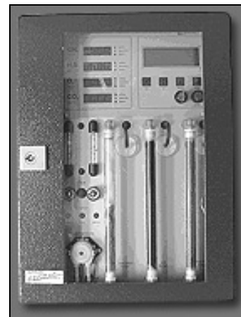
Abb. 3-46: Gasanalysegerät; Foto: Schmack Biogas AG
