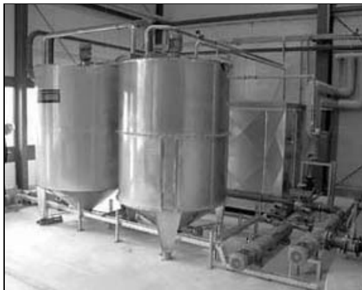
Abb. 3-16: Hygienisierung mit Rückkühlung Foto: TEWE Elektronik GmbH & Co. KG
