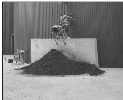
Abb. 3-40: Schneckenseparator; Zeichnung: FAN Separator GmbH; Foto: PlanET Energietechnik
