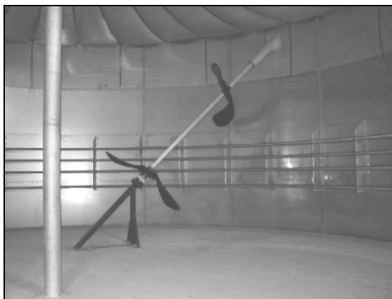
Abb. 3-37: Langachsrührwerke mit zwei Rührwerkzeugen mit und ohne Lagerung am Fermenterboden; Foto: WELtec BioPower GmbH; Grafik: Armatec FTS-Armaturen GmbH & Co. KG
