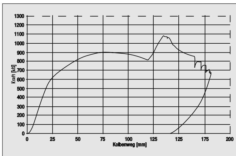
Bild 12: Kraft-Verformungskurve aus Dreipunktbiegeversuch
