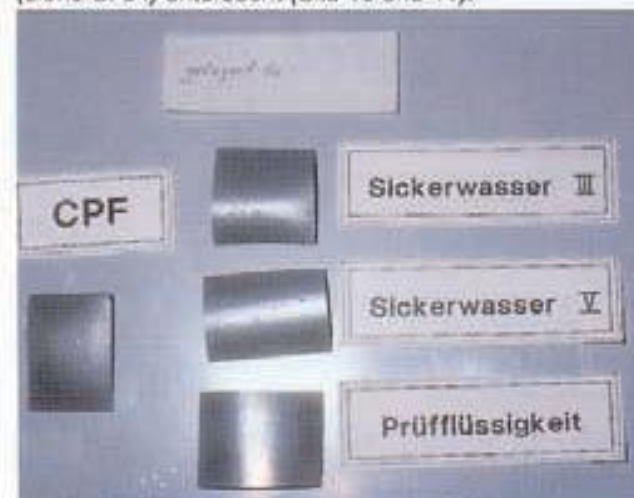
Bild 10: Beständige Stahldichtungen nach sechs Monaten Lagerung
