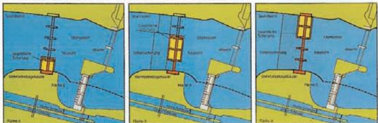
Bauphase I: Bau des 1. Wehrfeldes (1989)
