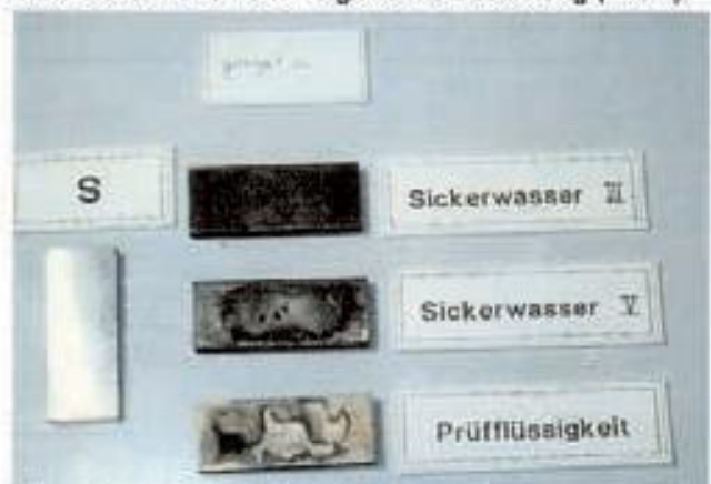
Bild 7: Korrosion von Stahl nach sechs Monaten Lagerung in Sickerwässern und in daraus entwickelter hochkonzentrierter Prüfflüssigkeit
