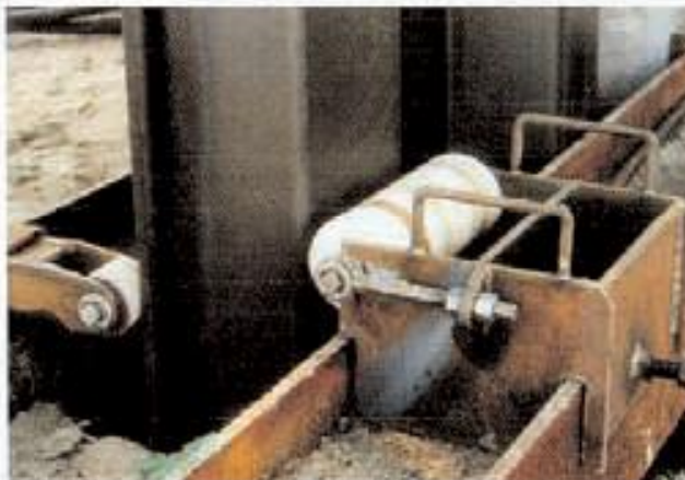
Bild 8: Rollenunterstützte Spundbohlenprüfung zum Schutz der Beschichtung
