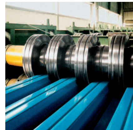
Abb. 8: Walzprofilieren von organisch bandbeschichtetem Feinblech
