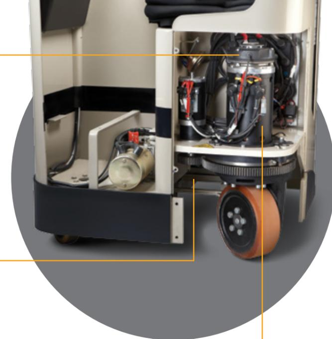
**Von Vorteil für die Bediener ist auch die proportionale Geschwindigkeitsreduzierung** bei Kurvenfahrten, die durch CAN-Bus-gestützte Kommunikation zwischen Fahr- und Lenksteuerung ermöglicht wird.
