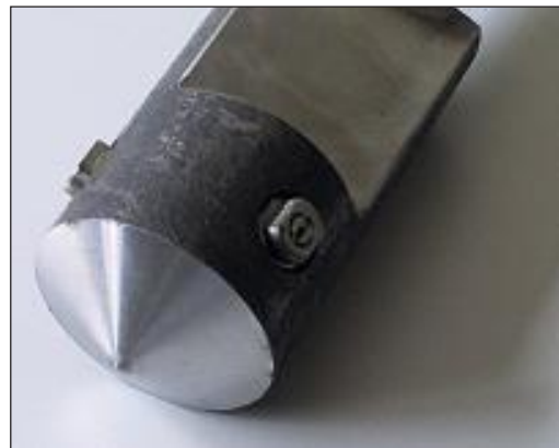
Bild 9: Trägerkopf mit Umlenkung des Spülstrahls
