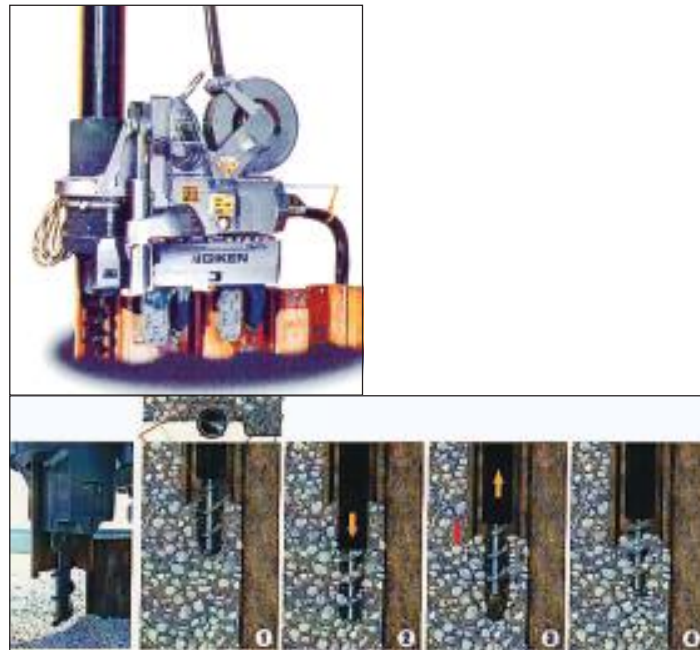
Bild 11: Silent Piler Typ „Crush Piler“ mit integriertem Bohrergerät im Presskopf für U-Profile
