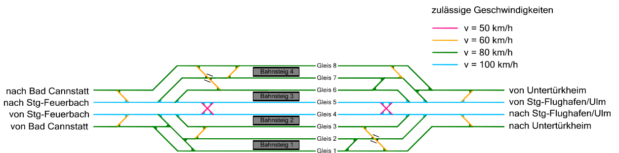
Abbildung 1 Gleis- und Weichengeschwindigkeiten im Hauptbahnhof
