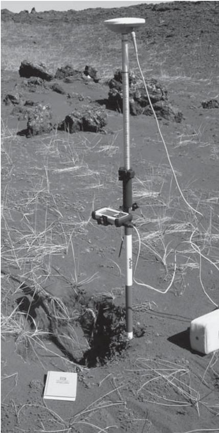
Kinematisches GPS (Rover-Einheit): mit diesem Gerät wurde die Háleyjabunga-Störung vermessen. Ein differentieller Post-processing der gemessenen Daten zu einer Basis-Station erlauben cm-genaue Messungen.
