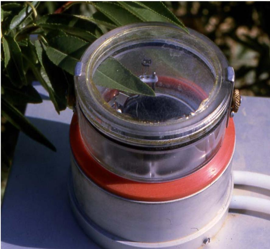
Abb. 1: Messung der Photosyntheserate eines Blattes eines Mandelbaumes (*Prunus dulcis*) in einer sogenannten Gaswechsellkuvette. Die Abnahme der  $\text{CO}_2$ -Konzentration in der Kuvettenluft durch die Photosynthese wird mittels Absorption der Infrarot-Strahlung bestimmt – das gleiche Prinzip, auf dem der Treibhauseffekt durch  $\text{CO}_2$  und andere Treibhausgase basiert
