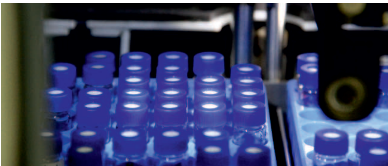
Blick in den Autosampler eines NANO-UPLC-Massenspektrometersystems, mit dem ein Enzym, das an der Reparatur geschädigter DNA beteiligt ist, analysiert wird. Bei Probeneingabe wird vom Autosampler der Deckel durchstoßen, eine Probe angesaugt und dann in das Analysensystem eingespritzt.
