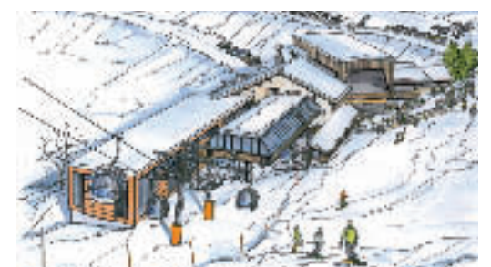
▲ DIE ERSTEN ENTWÜRFE DER BERÜHMTE KABINENBAHN MIT 10 SITZPLÄTZEN DER CÔTE 2000. IHR WICHTIGSTES INNOVATIVES ELEMENT: DER STILLSTAND DER KABINEN IN DER STATION FÜR DEN EINSTIEG VON PERSONEN MIT EINGESCHRÄNKTER MOBILITÄT
