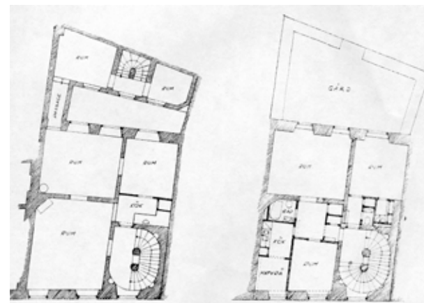
Lägenhetsplan före och efter sanering. Kv. Cepheus.
