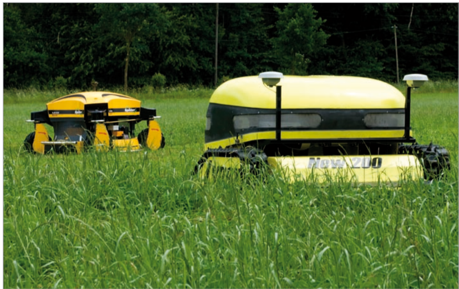
Zwei ferngesteuerte Rasenmäher bei einer Präsentation. Der hintere vierrädrige Rasenmäher wurde zu einem autonomen Roboter umgebaut. Er kann verschiedene Sensoren tragen, um den Pflanzenstatus zu begutachten.
