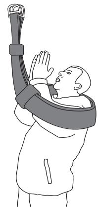
Einstieg bei geschlossener Rettungsschlinge
