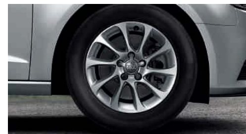
Aluminium-Gussräder im 10-Speichen-Design Größe 6,5 J x 16 mit Reifen 205/55 R 16
