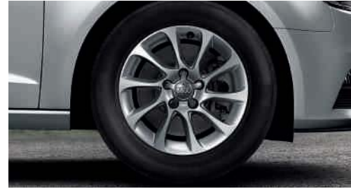
Winter-Aluminium-Gussräder im 10-Speichen-Design Größe 6,5 J x 16 mit Reifen 205/55 R 16, zulässige Höchstgeschwindigkeit 210 km/h
