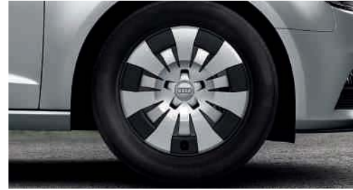
Winter-Stahlräder inklusive Radvollblende Größe 6 J x 16 mit Reifen 205/55 R 16, zulässige Höchstgeschwindigkeit 210 km/h, schneekettentauglich
