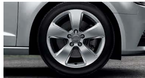
Winter-Aluminium-Gussräder im 5-Arm-Design Größe 6 J x 17 mit Reifen 205/50 R 17, zulässige Höchstgeschwindigkeit 210 km/h, schneekettentauglich
