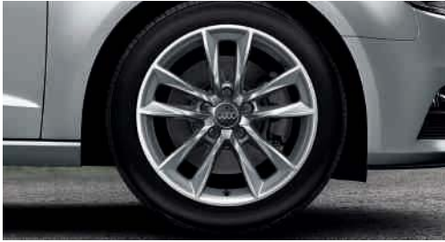
Aluminium-Gussräder im 5-Arm-Kinetik-Design Größe 7,5 J x 17 mit Reifen 225/45 R 17 (wahlweise mit Reifen mit Notlaufeigenschaften)
