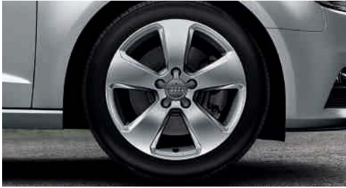
Aluminium-Gussräder im 5-Arm-Design Größe 7,5 J x 17 mit Reifen 225/45 R 17 (wahlweise mit Reifen mit Notlaufeigenschaften)
