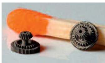
Metallische Bauteile bis in den Bereich weniger Mikrometer fertigt EOS.
