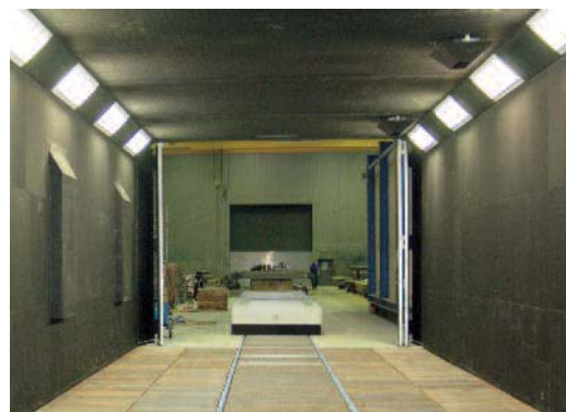
Freistrahlanlage 22 x 5,3 x 4,5 m mit elektrisch angetriebenen Schienenwagen.
