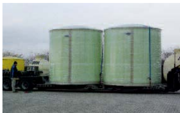
Zwei im Großröhrsdorfer Werk gefertigte Flachbodentanks. Sie wurden ebenfalls für die Streusalzeinlagerung an die Straßenmeisterei München geliefert.
