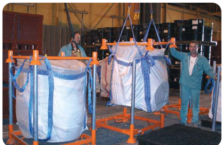
Mise en place des big-bags à SOCATRI avant chargement en container pour départ vers l'ANDRA
