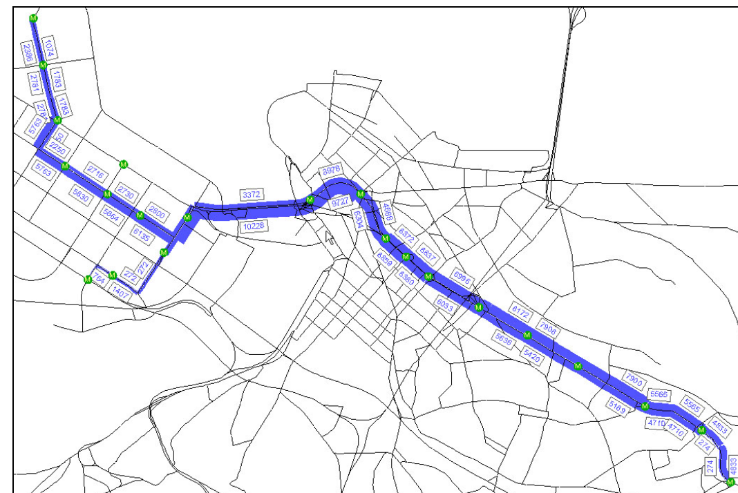
Slika 8. Opterećenje I linije LM, jutarnji vršni sat, 2011.godina, Osnovna varijanta
