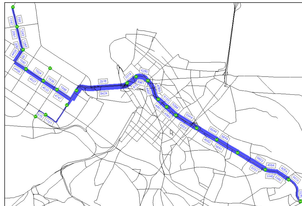
Slika 10. Opterećenje I linije LM, jutarnji vršni sat, 2022.godina, Varijanta sa stanicom Akademija
