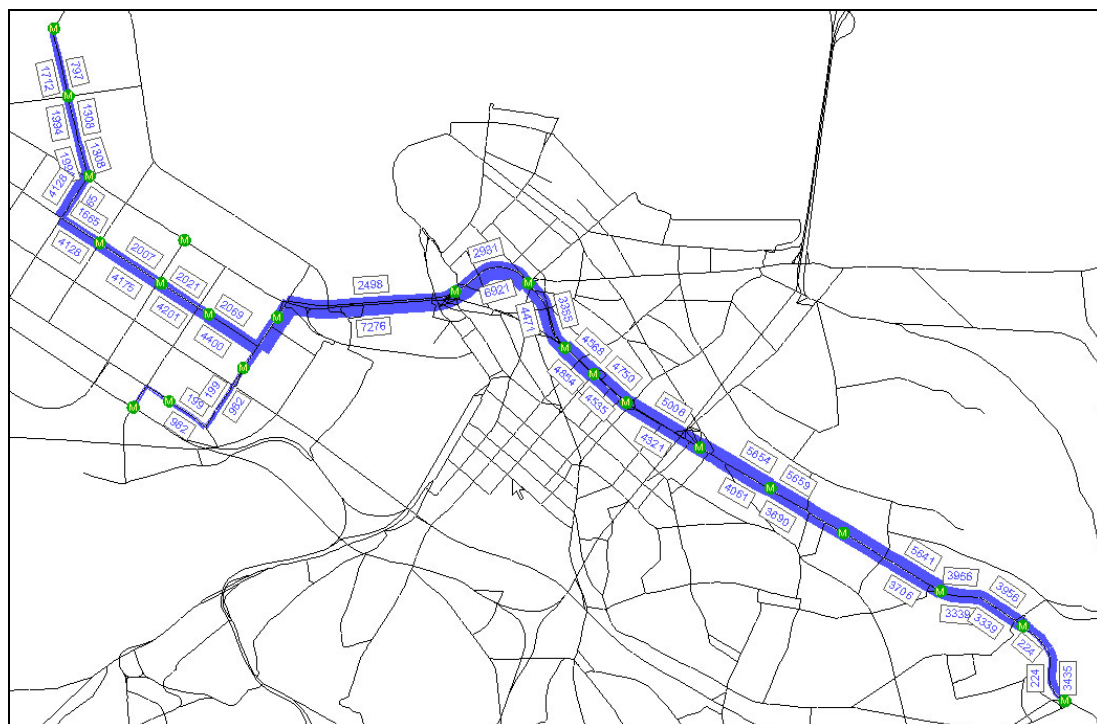
Slika 7. Opterećenje I linije LM, jutarnji vršni sat, 2002.godina, Osnovna varijanta
