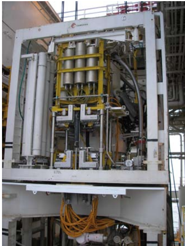
Abb. 1 | Blowout-Preventer des japanischen Tiefbohr-Forschungsschiffes CHIKYU. Er wiegt rund 380 Tonnen, ist etwa 14,5 Meter hoch und kann einem Druck von etwa 103 MPa widerstehen. Foto: Jan Behrmann, IFM-GEOMAR
