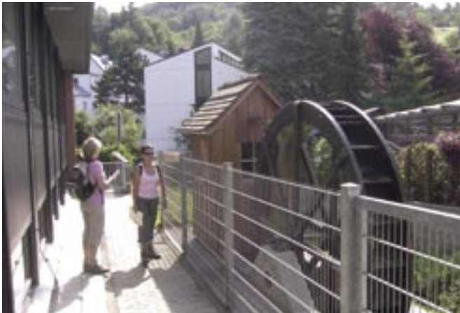
Das Mühlendenkmal Nieder-Beerbach, 2002 gebaut von geschichtsbewussten Mitgliedern des Obst- und Gartenbauvereins Nieder-Beerbach: Das ober-schläch-tige Rad hat einen Durchmesser von 3 m und eine Breite von 55 cm.
