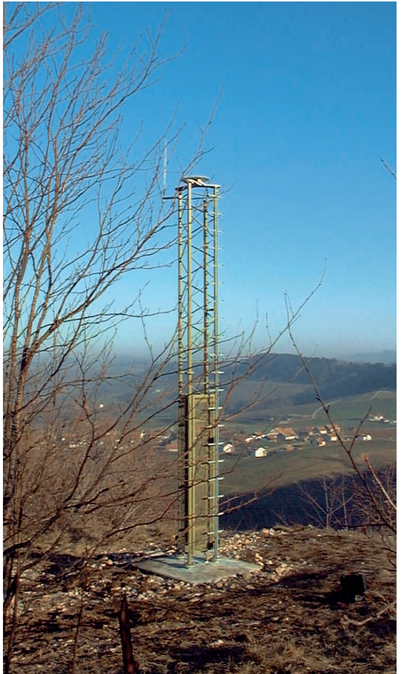
Abbildung oben: Permanente Satelliten- messstation als Fix- punkt der neuen Landesvermessung
