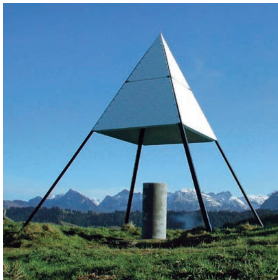
Abbildung oben: Permanente Satelliten- messstation als Fix- punkt der neuen Landesvermessung
