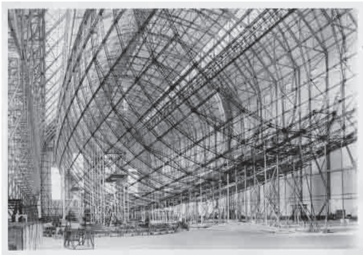
Flug 05: Das Aluminiumgerippe des Luftschiffes LZ "Graf Zeppelin" überlassen von: Herrn Dr. Borns
