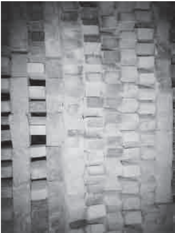
Ziegel 15: Aufgeschichtete grüne Ziegel im Brennofen in der Ziegelei Hundisburg überlassen von: Herrn Dr. Borns
