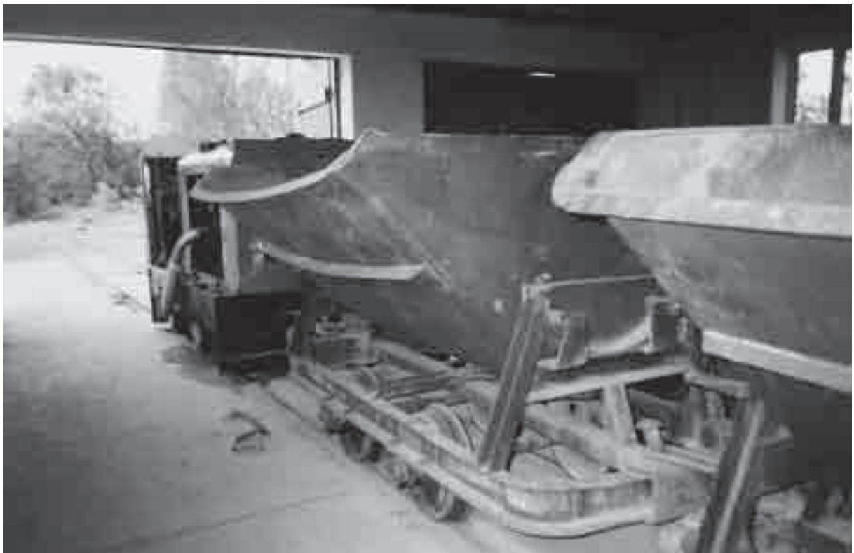
Ziegel 05: Kipploren mit Diesellok in der Ziegelei Hundisburg überlassen von: Herrn Dr. Borns
