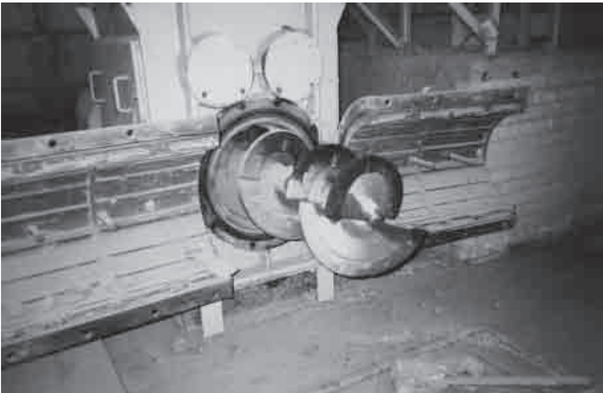
Ziegel 08: Geöffnete Ziegelpresse in der Ziegelei Vehlitz überlassen von: Herrn Dr. Borns
