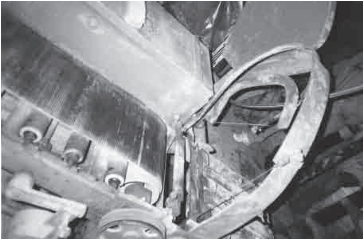
Ziegel 09: Drahtabschneider in der Ziegelei Hundisburg überlassen von: Herrn Dr. Borns
