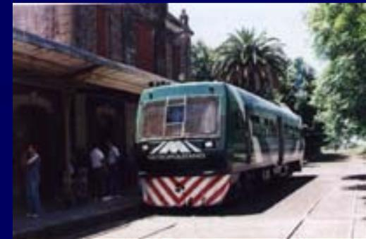
CML 1 Materfer (Córdoba '80). Capacidad 56 pasajeros sentados. Velocidad operativa 60 km/h. Tracción Diesel Convertida Biodiesel
