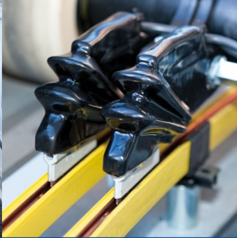
(links) Kunststofftrichter und Stromschienen (unten) Stromabnehmer
