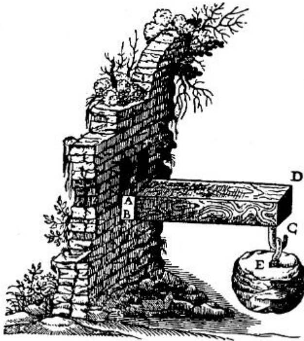
Abb. 22. Eingespannter, am freien Ende belasteter Balken. Aus: GALILEI, Discorsi e dimostrazioni matematiche , Leiden 1638.
